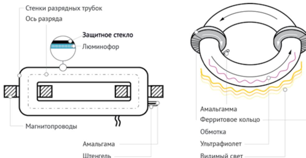
Принцип работы лампы основан на электромагнитной индукции и газовом разряде для генерации видимого света. Индукционный разряд возбуждается высокочастотным электрическим полем, образуя замкнутый плазменный виток. Под воздействием УФ излучения разряда происходит свечение люминофора.
