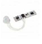
профиля для работы датчика. Длина кабеля 60мм. Для профилей с внутренней высотой (пов. профиля - пов. экрана) от 10 до 20 мм. 12-24V, 5A. Размер платы 40x11x12мм, размер датчика: D12x10мм.
