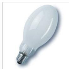
В ртутной лампе используется излучение электрического разряда в парах ртути. У этих ламп высокая светоотдача при относительно небольших габаритах и длительный срок службы. 40% излучения приходится на ультрафиолетовую область спектра. Для увеличения светоотдачи ультрафиолетовое излучение преобразуют в видимый свет с помощью
