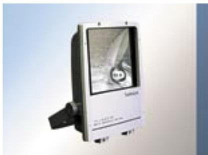
Высокоэффективные прожектора с встроенными пускорегулирующими аппаратами (ПРА) с асимметричными мало слепящими световыми пучками, распределяемыми ниже горизонтальной плоскости. Для достижения хорошей цветопередачи в них применяются металлогалогенные лампы (МГЛ).
