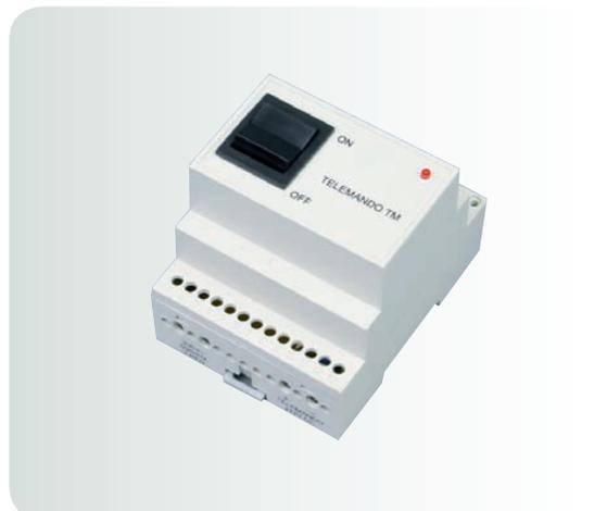
С помощью устройства TELEMANDO осуществляется контроль и управление аварийным освещением. Контроль аварийным освещением заключается в имитации включения аварийного режима для проверки работоспособности светильников и устранения неполадок, если таковые имеются. Управление же заключается в отключении аварийного режима, если это необходимо. Возможно подключение различных типов аварийных светильников, а также установка на DIN-рейку.
