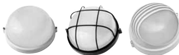
Влагозащищенные светильники типа NBL-R круглой формы предназначены для использования с лампами накаливания со стандартным цоколем E27 и поставляются в двух типоразмерах – для ламп максимальной мощностью 60 Вт и 100 Вт и степенью защиты от воздействия окружающей среды IP54.
